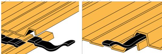
Figure 1 - Exemples de recouvrement transversal et longitudinal sur couverture métallique nervurée
