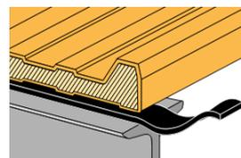
Figure 2 - Exemple de mise en oeuvre sur panne en couverture panneaux sandwichs
